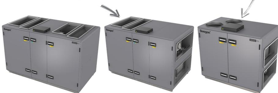
L'échangeur de chaleur rotatif RECOeconomic / RECOsorbic à rendement thermique peut atteindre 85 %. La quantité de chaleur requise est réglée automatiquement et de manière variable par la vitesse du rotor. L'échangeur de chaleur rotatif récupère également avec efficacité l'énergie de refroidissement.
